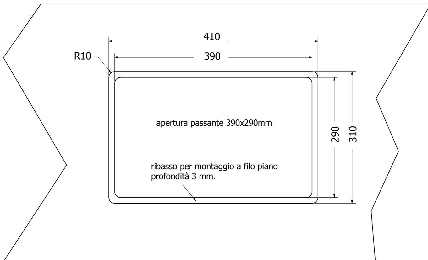
A tutte le quote espresse in millimetri aggiungere una tolleranza minima per l'inserimento del supporto incasso tablet. Per il montaggio a filo del piano predisporre un ribasso per la cornice con profondità 3 mm.
